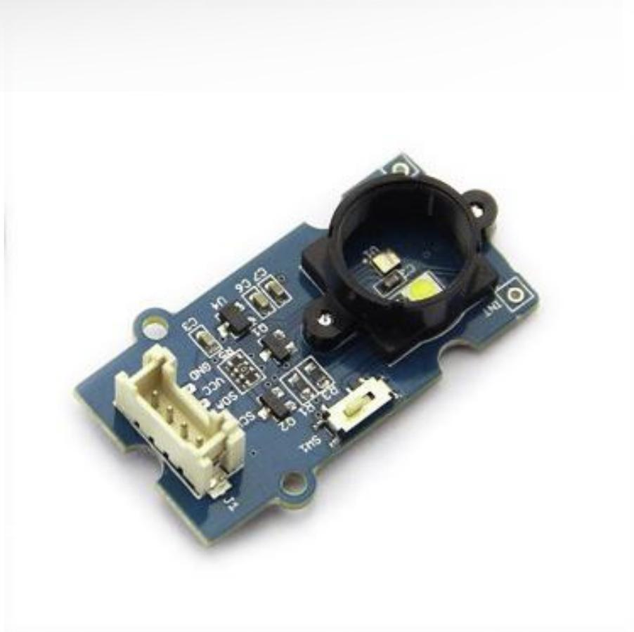
Capteur composé de 16 photodiodes avec différents filtres pour déterminer la couleur d'un objet.
