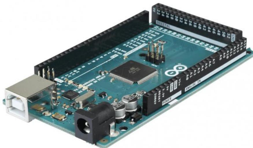
Interface basée sur le microcontrôleur ATmega2560.
