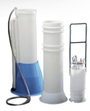
Ce système automatique de lavage de pipettes et de burettes permet un lavage rapide et efficace. Les dimensions de cet appareil permettent d'accueillir toute taille de pipettes et burettes. Le fond en polyéthylène élastique protège votre verrerie de la casse.
