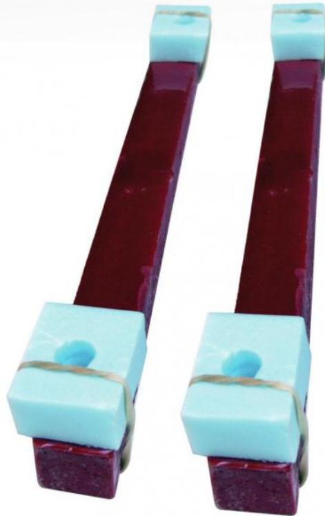
Ensemble de deux barres de cire permettant de mettre en évidence l'effet de la température sur la vitesse de propagation des ondes sismiques. S'utilise avec les piézomètres ou le kit SMCL.
