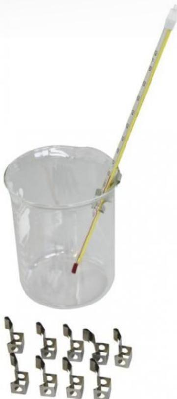
Supports se fixant sur le bord d'un bécher permettant de maintenir un thermomètre de diamètre 7 mm maximum et résistant jusqu'à une température de 120°C.
