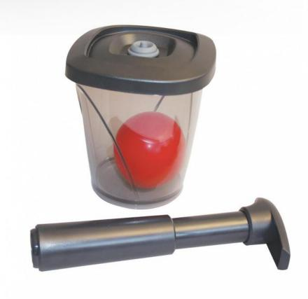
Mesure de la masse de l'air Gonflage d'un ballon de baudruche par dépression Mise en évidence de la variation de la température d'ébullition avec la pression
