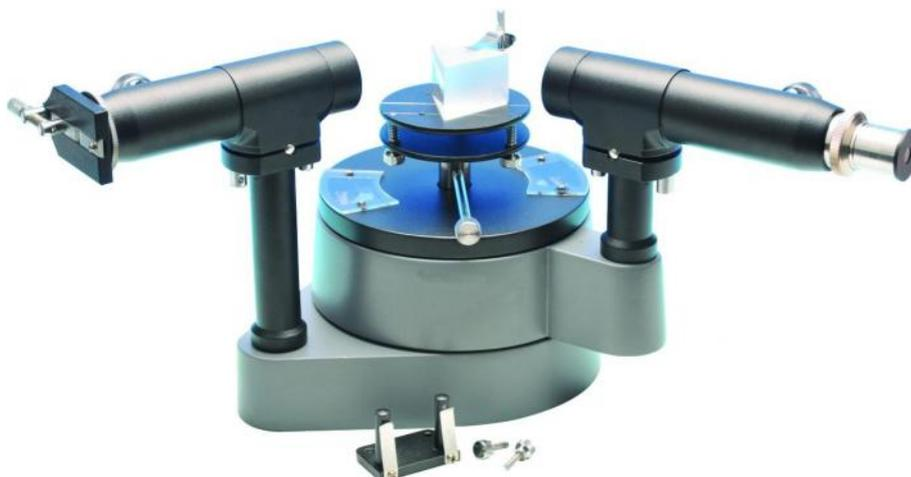
Ce spectrogoniomètre d'initiation permet de réaliser les expériences de base en spectroscopie telle que la mesure de l'angle et l'indice d'un prisme, le pas d'un réseau, etc.
