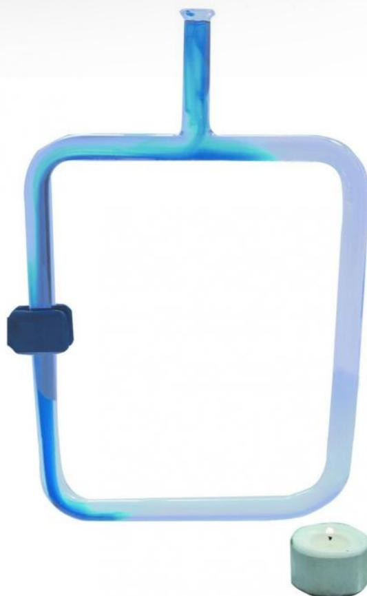
Ce tube de verre permet de visualiser le mouvement de convection d'un fluide. Remplir le tube d'eau et verser quelques gouttes de colorant. Allumer une bougie sous un angle du système et observer le colorant refluer à l'inverse de la source de chaleur.
