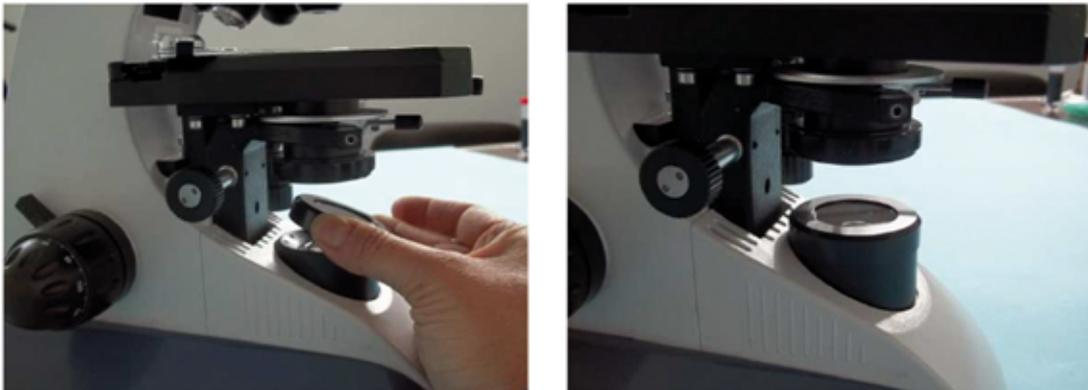
2) Sortir l'oculaire du tube ; l'analyseur doit être placé à l'intérieur de celui-ci :
