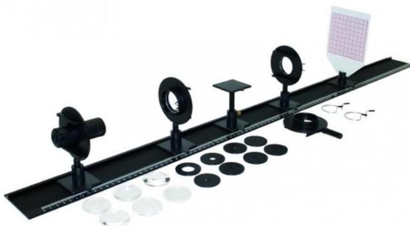
Ensemble complet permettant à de jeunes élèves d'expérimenter simplement et aisément les bases de l'optique au collège : étude des lentilles convergentes et divergentes, mesure d'une distance focale, etc. Le banc est composé de 3 rails en PVB emboîtables à la manière d'un puzzle. Il est livré avec une source à LED et son adaptateur secteur.
