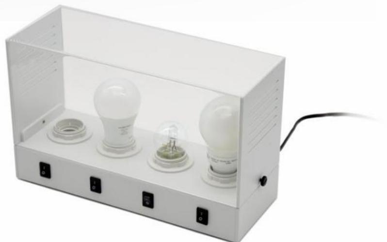
Ce banc test a pour but la comparaison de différents types d'ampoule : comparaison de la consommation électrique et de l'éclairage.
