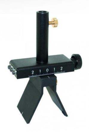
Cavalier à déplacement latéral Cavalier équipé d'un système permettant de déplacer l'axe latéralement.
