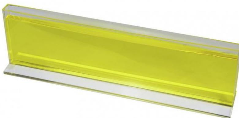
Grande cuve en plastique, parfaitement étanche, idéale pour effectuer des manipulations d'optique. Il suffit de remplir la cuve avec de l'eau, d'utiliser un pointeur laser et de visualiser la trajectoire du faisceau lumineux pour mettre en évidence des phénomènes comme la réfraction, la réflexion, ou bien encore la déviation d'un rayon lumineux par un gradient d'indice (en ajoutant du sucre au fond de l'eau).
