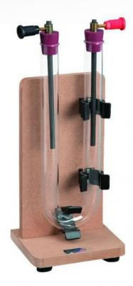
Dispositif permettant de réaliser différentes électrolyses : eau, chlorure de sodium, bromure de cuivre II, etc.
