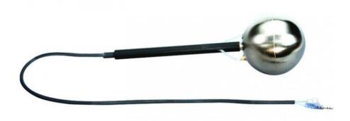
Cette enceinte hermétique possède des sondes de température et de pression. Utilisée avec un capteur de pression / température, l'enceinte permet alors d'étudier la loi de Charles : en la plongeant dans de l'eau à différentes températures, on obtient alors la pression et la température du gaz à volume constant.
