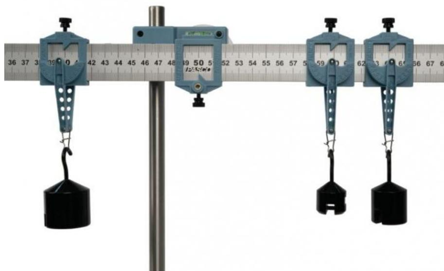
Version améliorée de l'équilibre d'une règle en montant le pivot sur un support de tige et en utilisant une règle en aluminium.
