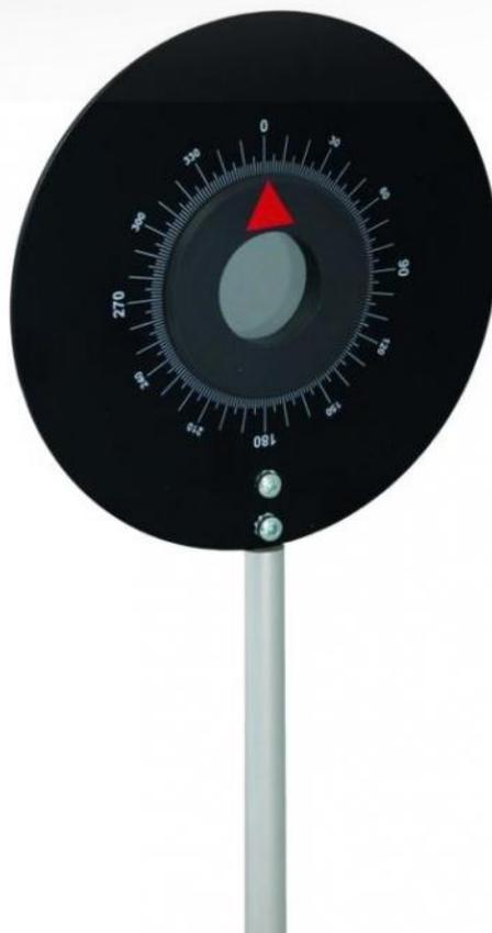
Support métal Ø120 mm avec 1 filtre polarisant sur support rotatif gradué
