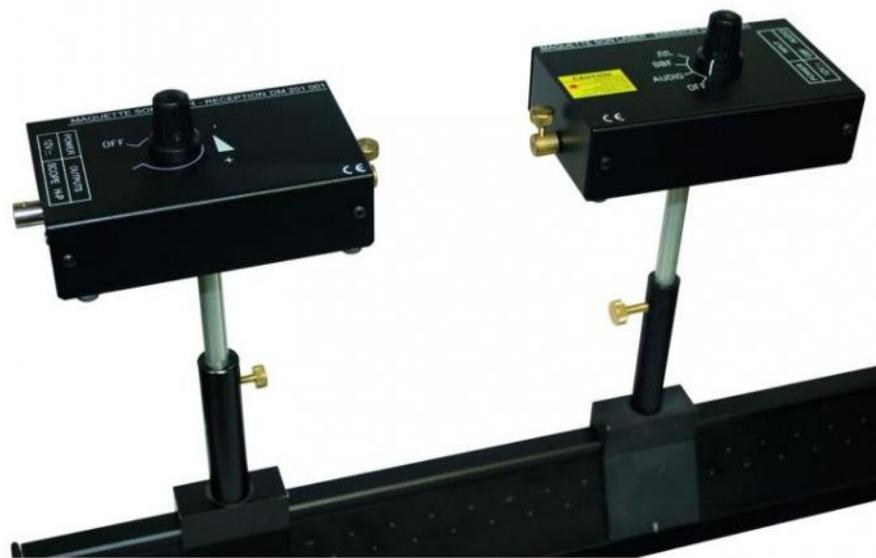
Maquette composée d'un module émetteur avec diode laser rouge, d'un module récepteur avec photodiode intégrée, et d'une fibre optique.
