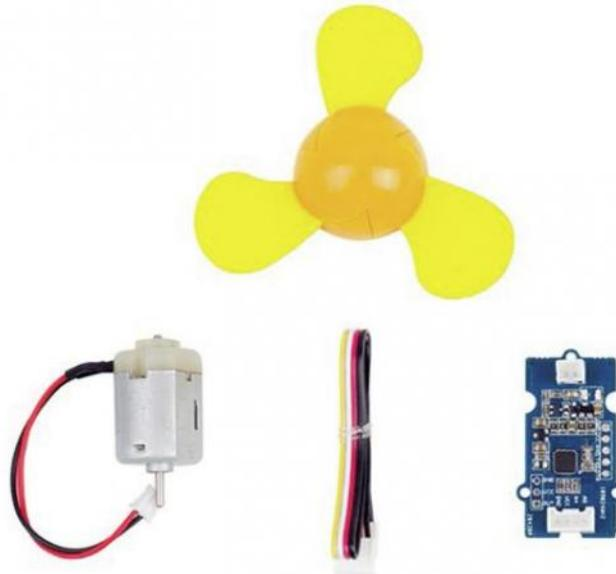
Petit moteur CC et hélice en caoutchouc. La vitesse de rotation dépend de la tension d'alimentation.
