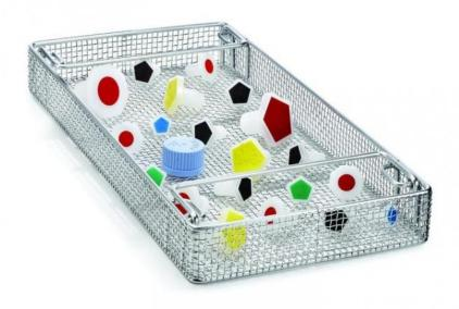
Panier avec poignées en acier inox, approprié au logement d'instruments de moyennes dimensions. Réalisé en mailles 5x5 mm.
