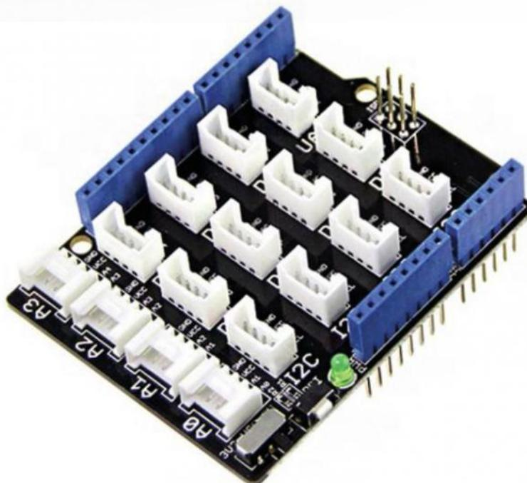
Le module Grove Base Shield est une carte d'interface permettant de raccorder facilement, rapidement et sans souder les capteurs et les actionneurs Grove sur une carte type Arduino UNO. Cette platine comporte un sélecteur le rendant compatible avec les microcontrôleurs 3,3 ou 5 Vcc.
