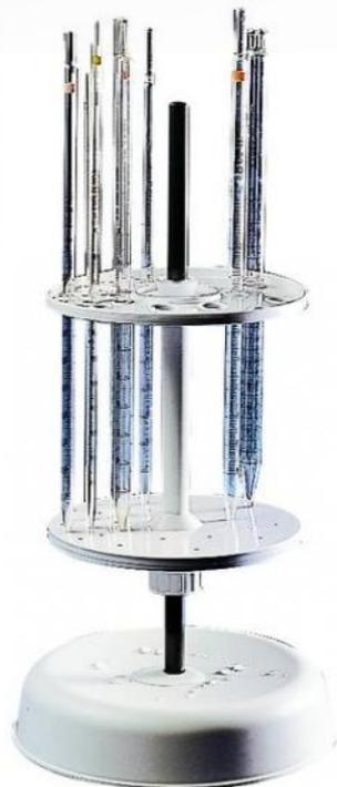
Support pour 18 pipettes de diamètre inférieur à 10 mm et 10 pipettes de diamètre inférieur à 15 mm.
