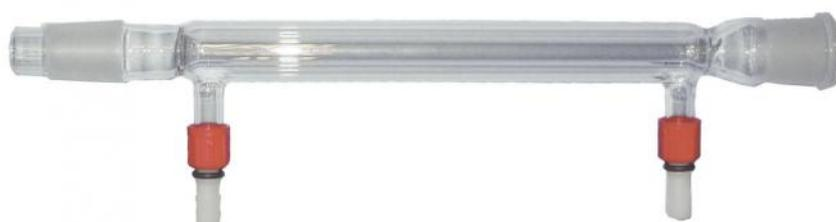
Réfrigérant droit raccords latéraux à vis.
