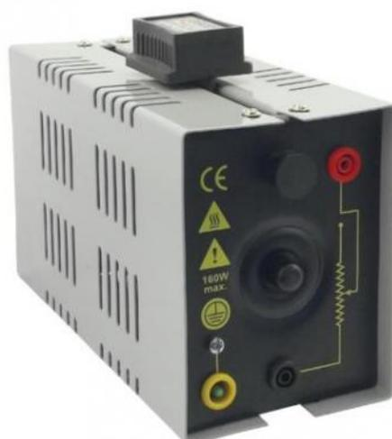
Cette large gamme permet de choisir le bon rhéostat en fonction de la résistance et de l'intensité souhaitées. En cas d'hésitation entre 2 modèles, il est toujours préférable d'opter pour le rhéostat qui accepte l'intensité la plus élevée, soit le modèle de 320 W.
