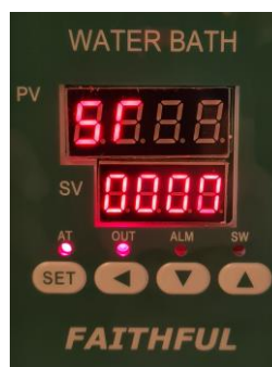
Mode ST (réglage de la minuterie) : laisser à 0000 pour que celle-ci ne soit pas prise en compte
